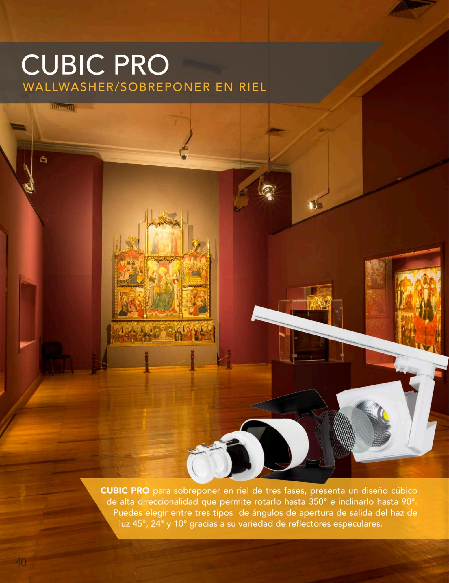
**CUBIC PRO** para sobreponeer en riel de tres fases, presenta un diseño cúbico de alta direccionalidad que permite rotarlo hasta 350° e inclinarlo hasta 90°. Puedes elegir entre tres tipos de ángulos de apertura de salida del haz de luz 45°, 24° y 10° gracias a su variedad de reflectores especulares.
