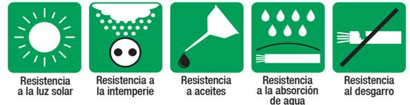
**NMX-J-061** Conductores - Cables multiconductores para distribución aérea o subterránea a baja tensión - Especificaciones.
