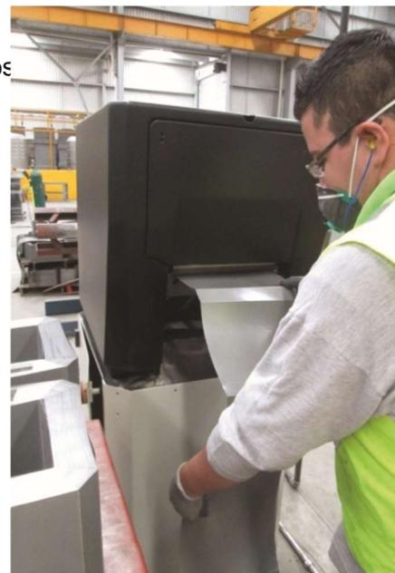
Los gabinetes son contruidos con láminas de acero al carbón o acero inoxidable, según se requiera, y se someten a un proceso de limpieza por granallado a metal blanco, aplicación de primario epóxico anticorrosivo y acabado en poliuretano de alta resistencia.
